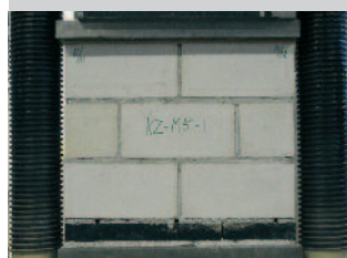
Bild 5: Druckversuch mit Mauerwerkswand aus Kalksandstein mit Mauerfußdämmung.
