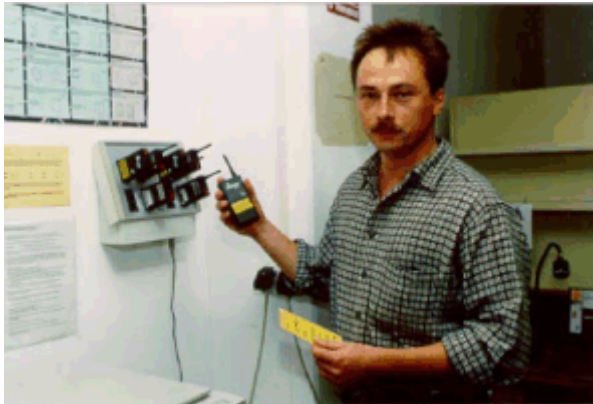
Bild 3: Funktionstest vor Arbeitsaufnahme; die Ladestation für Personen-Notsignal-Geräte ist dezentral angebracht
